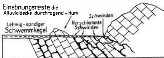
Abb. 3: Schema der Karstebenenbildung am Gegen-schüttungsrande eines Schwemmkegels aus wasser-unlöslichen Alluvionen
