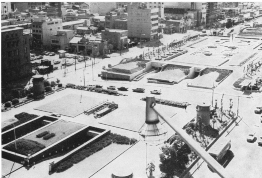
Photo 2: Innerstädtische Hauptachse in Nagoya Sakae-machi mit Zufahrten und Entlüftungsschächten der unterirdischen Parkfläche am U-Zentrum; oberirdisch stark gemischte Zentrenbebauung (7. 3. 1975)
