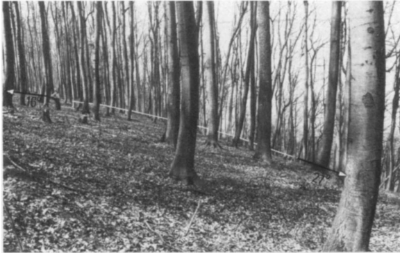
Photo 1: Kante mit einem Wölbungsradius von R = 92 m bei einer Hangneigungsänderung von 11^\circ Convex slope break with a radius of curvature of R = 92 m at a difference of inclination of 11^\circ
